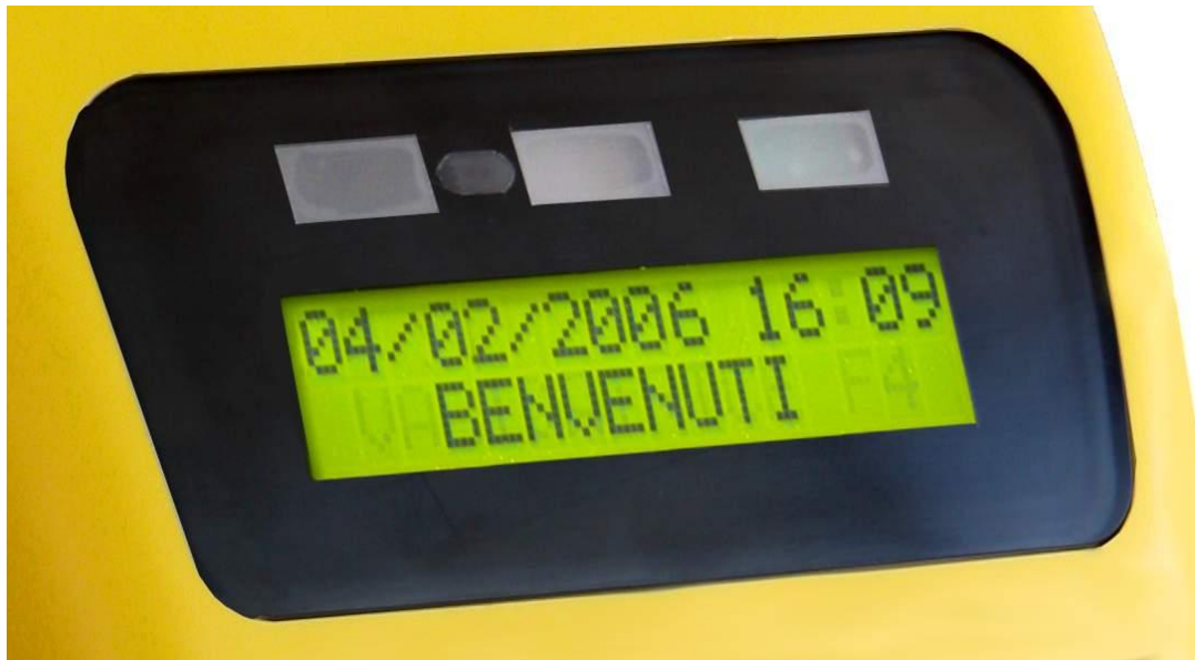
Il display 2x16 utilizzato in molte validatrici sormontato da tre luci di segnalazione.
