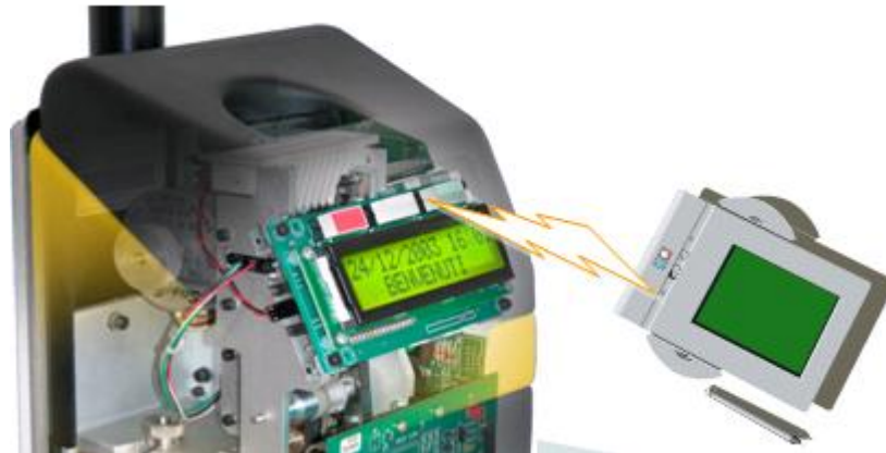
Comunicazione ad infrarossi tra validatrice e computer palmare
