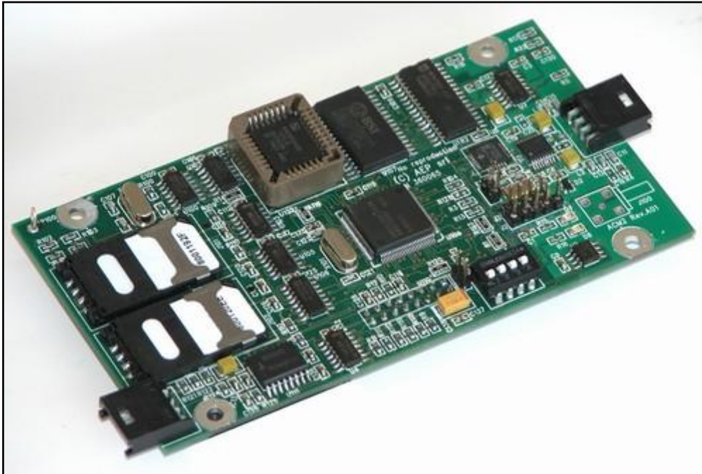
Un coupler intelligente reale – due moduli SAM sono visibili, altri due si trovano sul lato inferiore. Può processare vari standard ISO ed anche altri proprietari, come il MIFARE.
