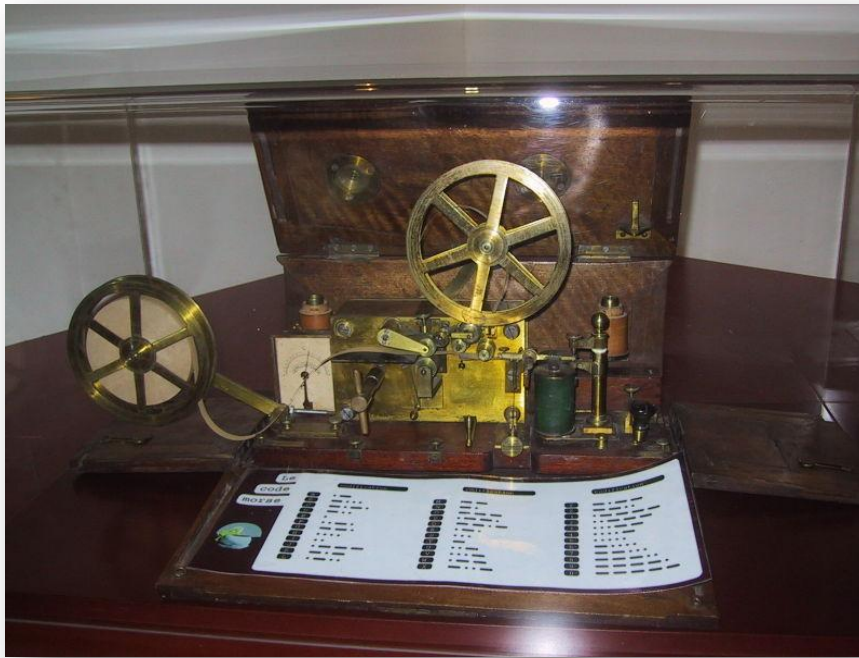
Un apparato telegrafico per codice Morse
