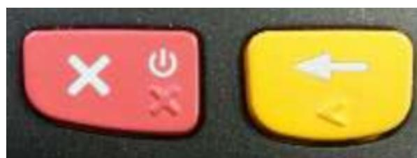
Затем выключаем аппарат, зажимаем желтую кнопку и не отпуская её нажимаем красную. На экране терминала появится надпись - «Prolin OS update» и начнется обновление.
